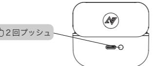
充電ケースのLEDが高速点滅するとペアリングモードへ移行します。
